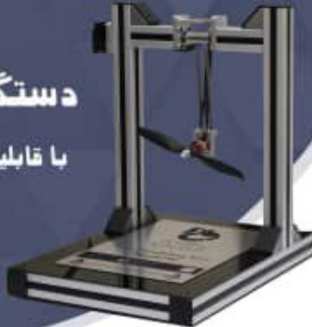
این دستگاه یک مجموعه آموزشی کنترلی است که برای بررسی عملکرد سیستم کنترل زاویه استفاده می‌شود. سازه مکانیکی، موتور براشلس و ملخ، حسگر توری، بردهای الکترونیکی، مازول واسط کاربر، نرم افزار رابط کاربر و وب سایت آزمایشگاه مجازی اجزای اصلی این دستگاه را تشکیل می‌دهند. بر مبنای الگوریتم کنترلی، موتور به نحوی تحریک می‌شود که با ایجاد نیروی لازم نهایتاً آونگ به زاویه مطلوب برسد.
